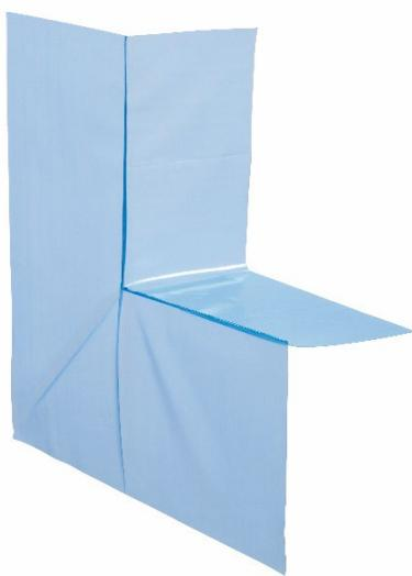
PAROC tvaika barjeras stūris (XMV 002) ir gatavs stūra elements, kas kausējot izgatavots no 0,20 mm biezas tvaika barjeras membrānas. Stūris ir paredzēts, lai atvieglotu tvaika barjeras slāņa blīvēšanu stūros ap logiem un durvīm. Elementa 90 grādu leņķis ir piemērots rāmja platumam 125, 170 un 200 mm. Blīvējot siju savienojumus, stūri var uzstādīt abās sijas pusēs.
