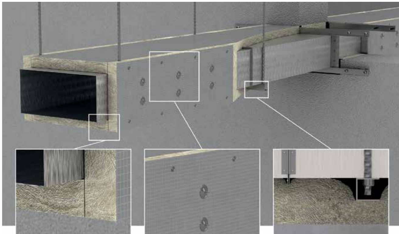
Att.3. Taisnstūra gaisa vadu ugunsdrošības izolācija ar plāksnēm
